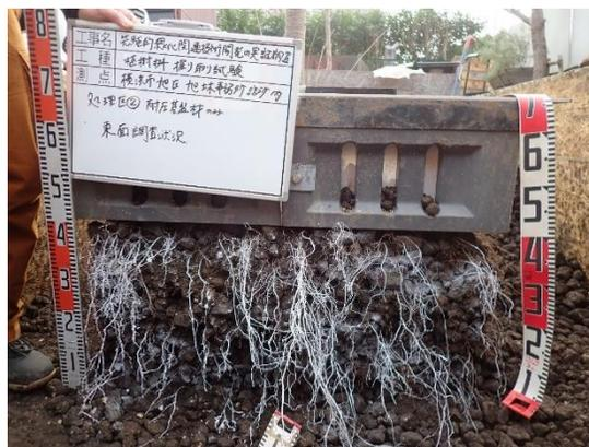
処理区B(耐圧基盤材)で施工した地盤は、細根が四方に分散し、健全な成長を確認
