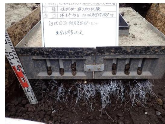
貯留浸透トレンチを施した処理区C地盤は、処理区Bよりは発根量が少ないが、トレンチ側への細根量は多く確認された
