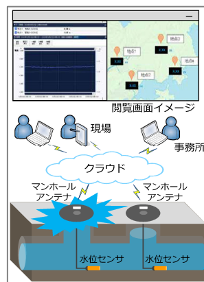
図 マンホールアンテナのイメージ
