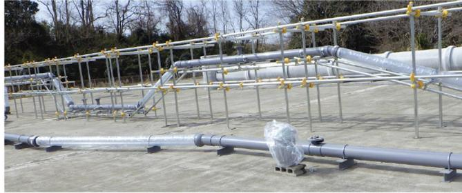
図-5 水平方向の曲がり部（手前左側）及び鉛直方向の曲がり部（奥）
