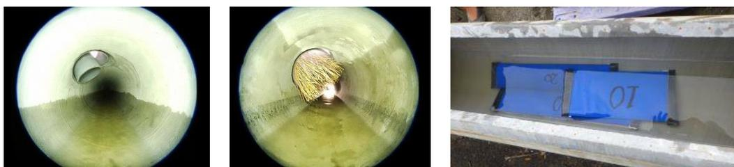
図-4 断面障害部の模擬状況 (左:取付け管突出し、中:樹木根侵入、右:土砂堆積)
