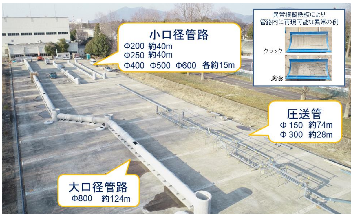
図-1 下水道管路模擬施設の概要
