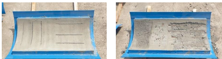
図-3 異常模擬鉄板 (φ400~600) (左:クラック、右:腐食)
