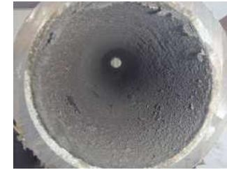
平成4年設置 ダクタイル鋳鉄管φ100 圧送管(ディスポーザー11戸、圧送距離2.5km地点)
