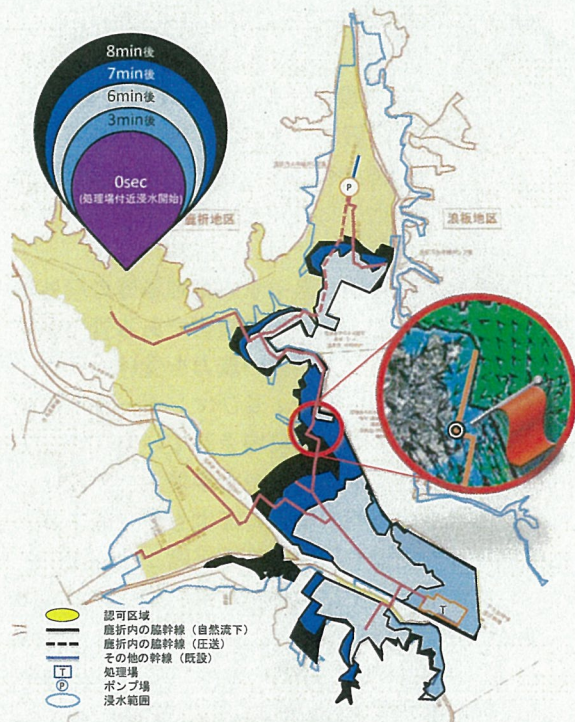
図-2 津波による浸水範囲の時系列変化 12)
