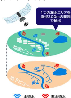
人工衛星を用いた漏水検知手法
