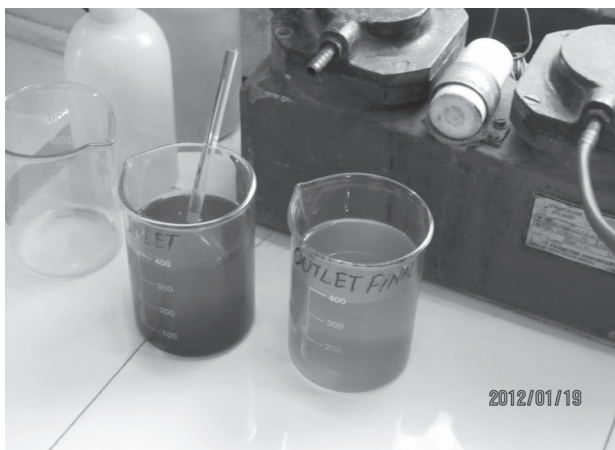
写真1 ヤムナ川流域の下水処理場の流入水(左側)と放流水(右側)の水質状況(2012年1月19日筆者撮影)
