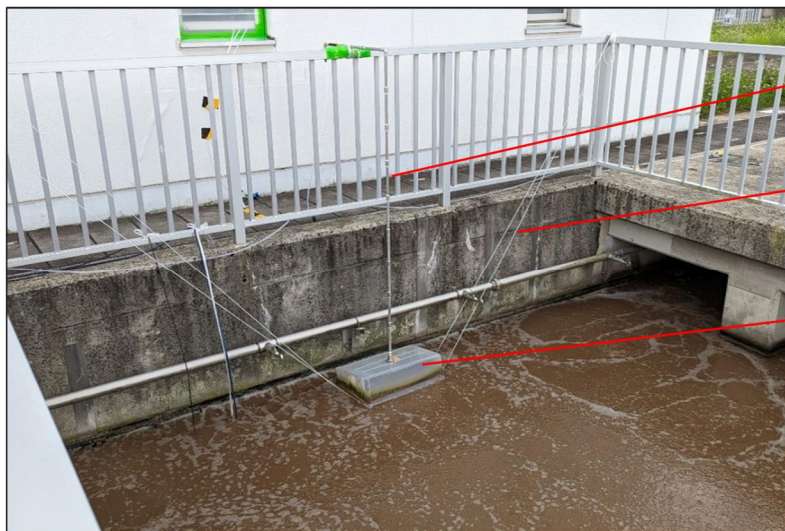
写真 4.4 フロートチャンバー設置の例
