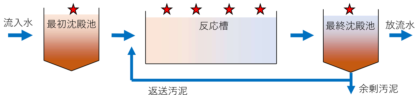
N 2 O排出量の空間変動を考慮した試料採取のイメージ図
