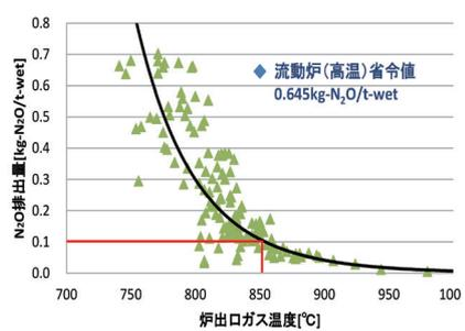
流動炉と比較して、N<sub>2</sub>O排出量約1/6
