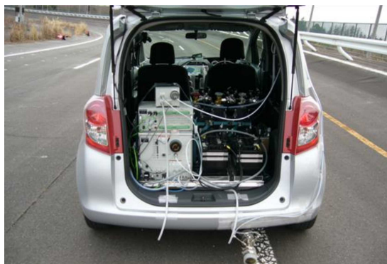
図-1 車載型排出ガス計測システム搭載状況
