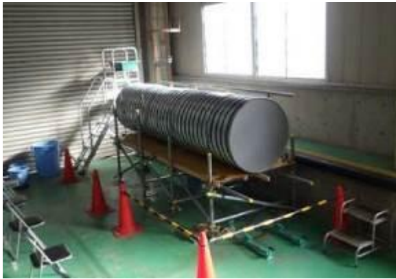
写真- 4.2.1 中空型枠試験体の設置状況
