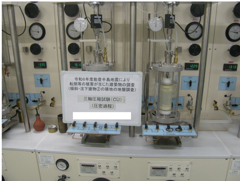
室内土質試験 力学試験 三軸圧縮試験 (CUb) 圧密過程
