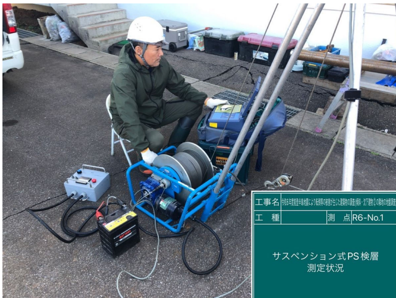
ボーリング工 R6-No.1 PS検層 サスペンション式 測定状況
