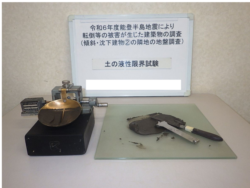
室内土質試験 物理試験 土の液性限界試験
