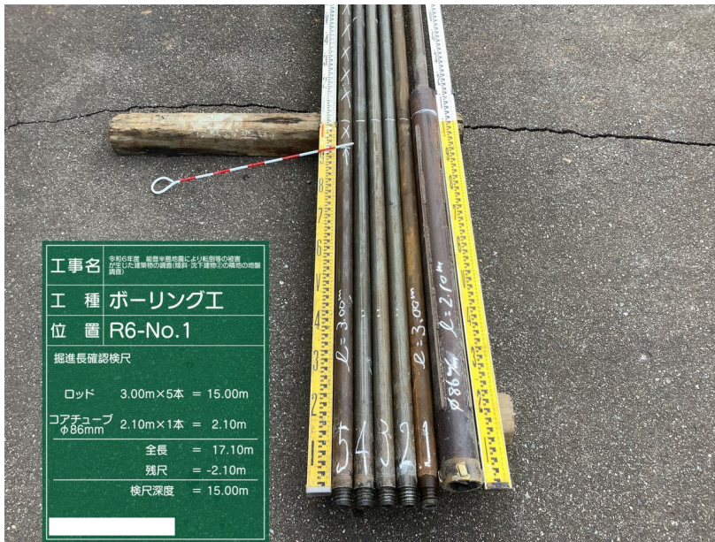
ボーリング工 R6-No.1 掘進長の確認 検尺深度 15.00m 近景下部
