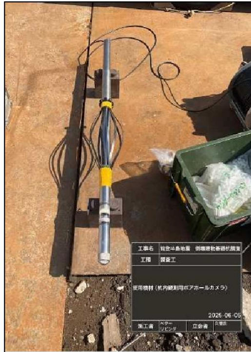
写真 3.1.4-3 ボアホールカメラ
