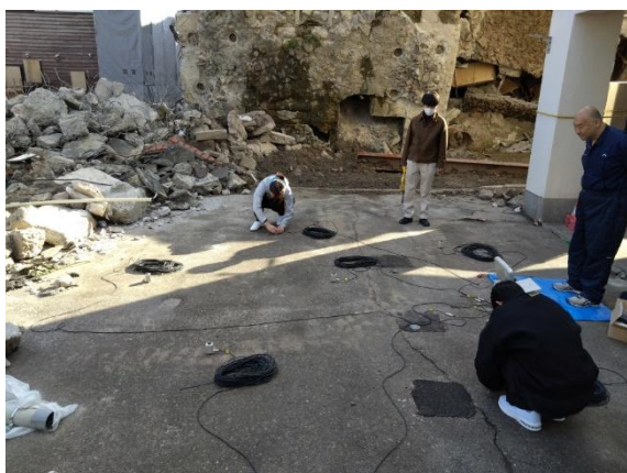
写真 3.3.1-1 調査中の様子（センサ設置）
