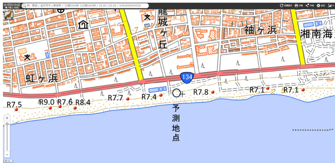
図-3.2.2.33 遡上痕跡の計測結果 (Shimozono et al. ; 2020、地理院地図に加筆)
