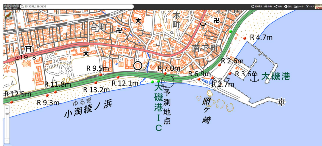
図-3.2.2.28 遡上痕跡の計測結果 (Shimozono et al. ; 2020、地理院地図に加筆)
