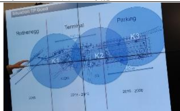
3 台のクレーン配置計画図
