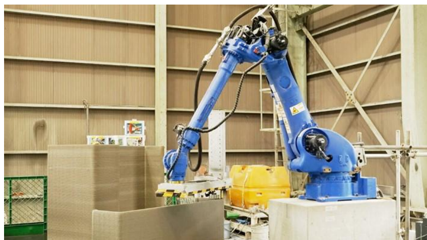
写真 4-2 建設用 3D プリンタの一例 ロボットアーム型 4.10)
