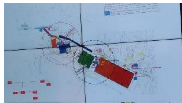
設置済みの 2 台のクレーンの配置図②
