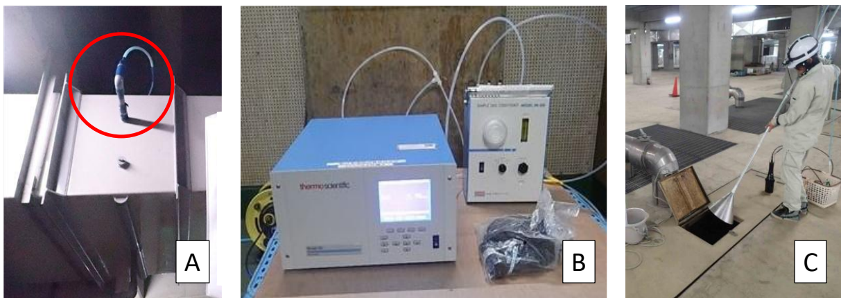
図2 N 2 O調査の様子（A：排気ダクトからの空気引き込み地点（対象地点③および④）、B：N 2 Oの自動測定器、C：生物反応槽からの空気試料の採取）
