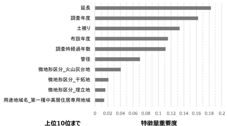
図5 ランダムフォレストによる劣化予測モデルの特徴量重要度（目的変数がたるみの場合）
