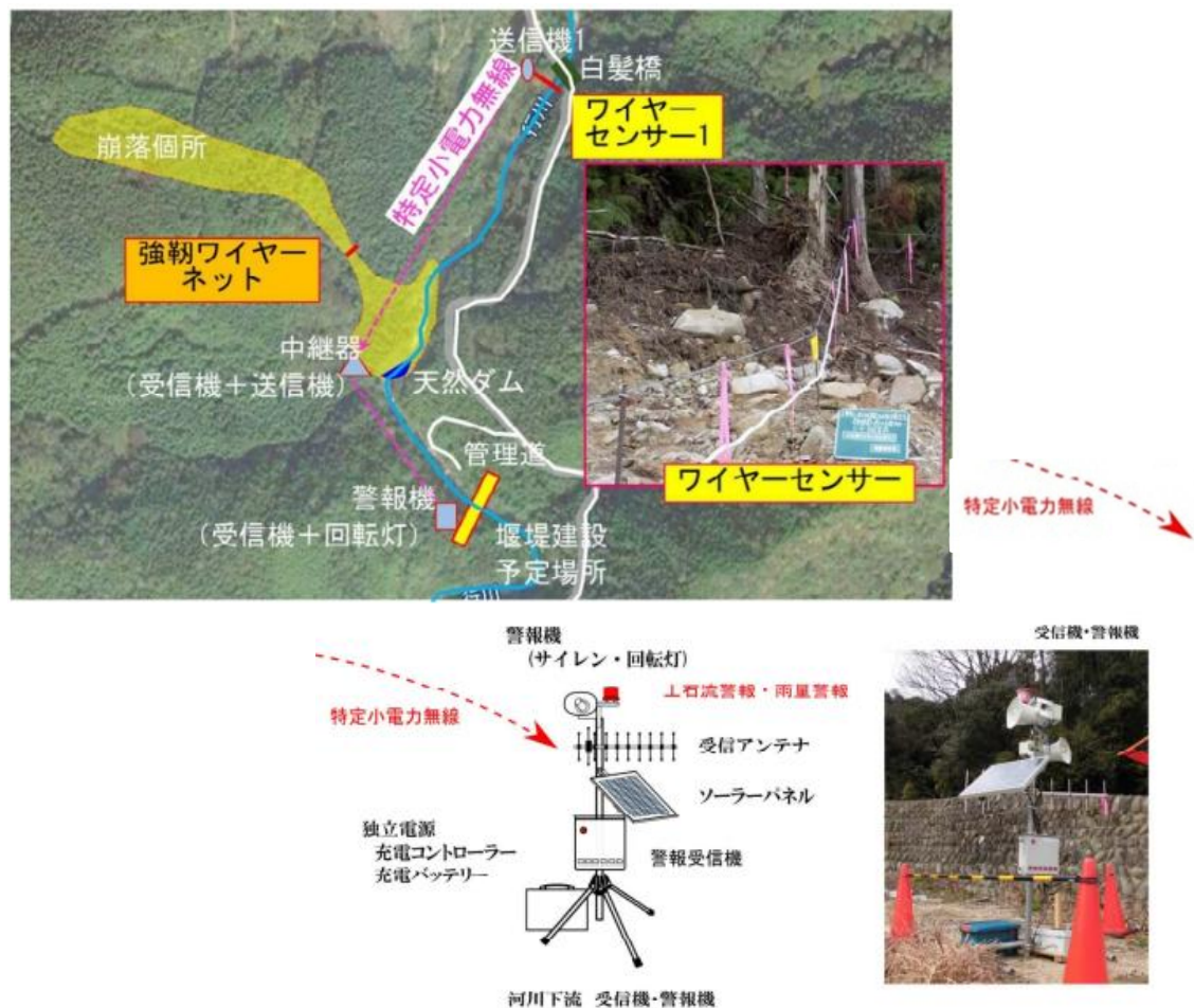
図-2-5-19-3 土石流監視警報システム概要
