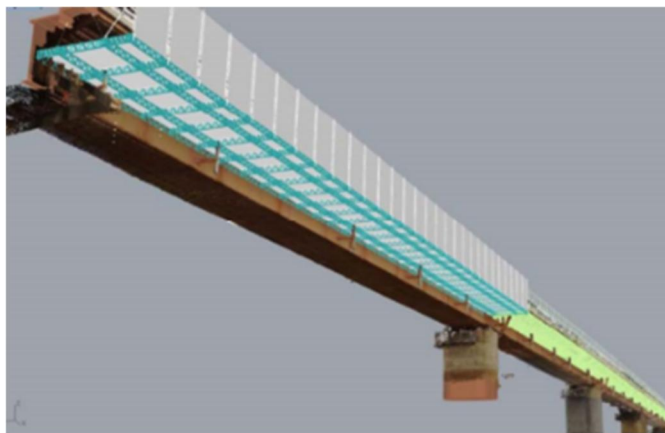
図-2-5-3-1 BIM/CIM による足場確認
