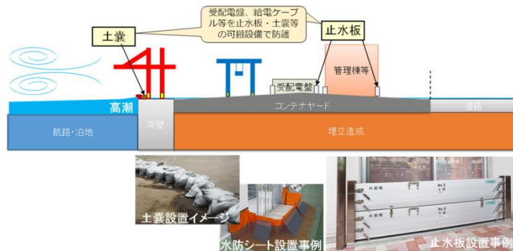
図-C.3 浸水被害に対するコンテナターミナルにおける可搬設備を用いた直前対策の事例
