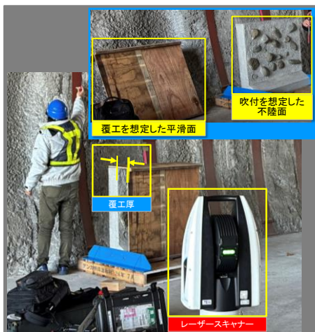
図-2 トンネル覆工厚の模擬計測
