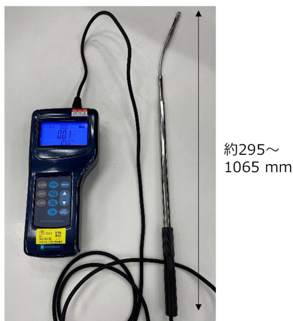
図資 4-5 ダクト内風速測定で用いた熱式風速計
