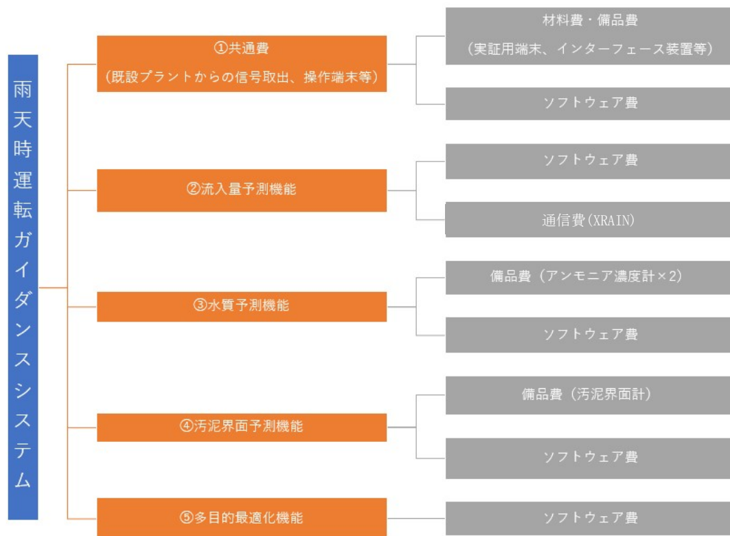
図3-2 雨天時運転ガイダンスシステムの費用構造
