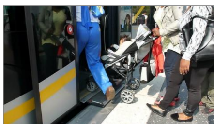
⑥ 段差・隙間の最小化と自動ステップでベビーカーや車椅子のスムーズ乗降（ナント）
