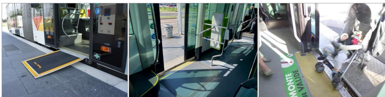
フルフラットで扉も広く、スロープは自動的で迫出す構造 (ストラスブール/メッス)
