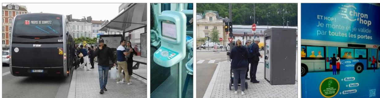
①信用乗車方式による連節バス全扉乗降車内の各扉に複数台設置された非接触式カード読み取り機／バス停留所に設置された事前購入用券売機（バイオンヌ）
