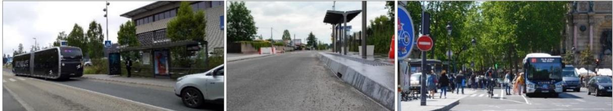
連節車両発着に十分な長さのバスペイ、後続車両は追い越しさせない（バイヨンヌ）
