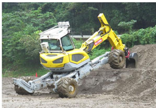
写真-11.3.5 4輪4脚式油圧ショベル
