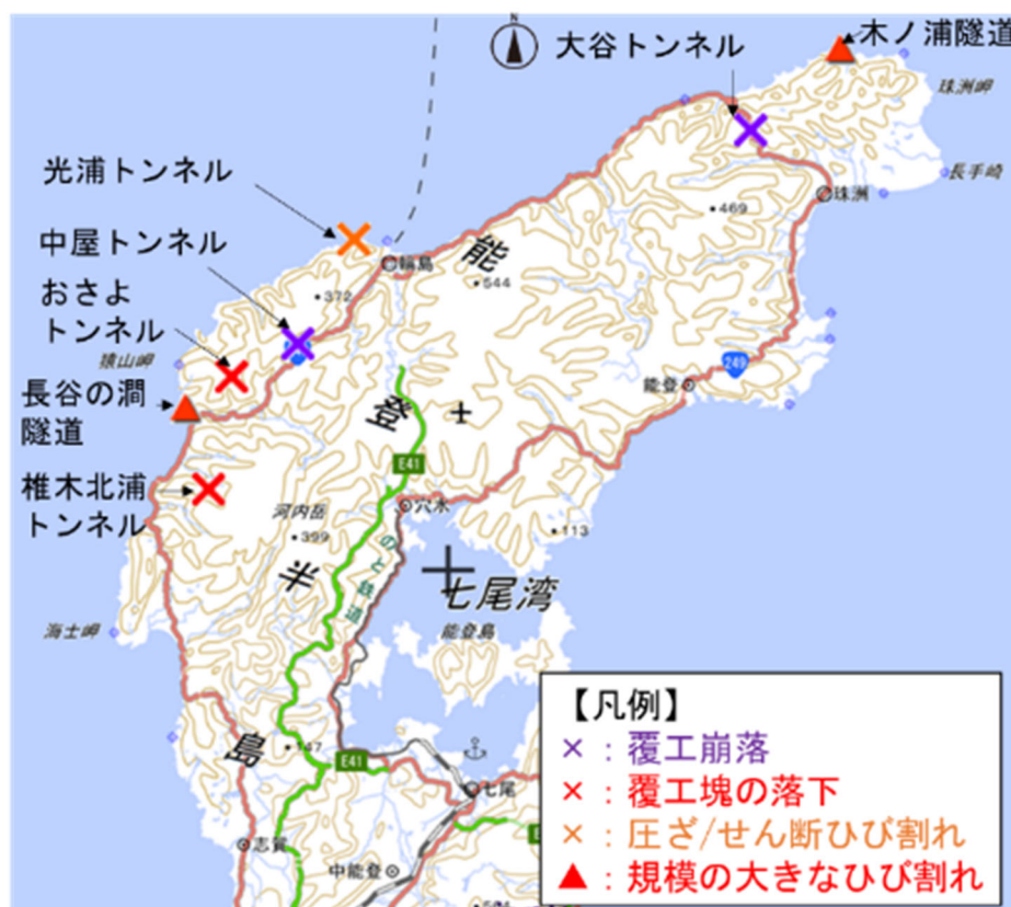
図-9.4.21 比較的大きな被害を受けたトンネル 8) を編集
