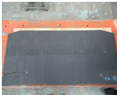
解図 4.2.6 試験体の破壊状況の例（左：接着補強、右：ねじ補強）
