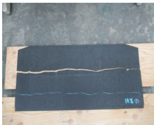
解図 4.2.6 試験体の破壊状況の例（左：接着補強、右：ねじ補強）
