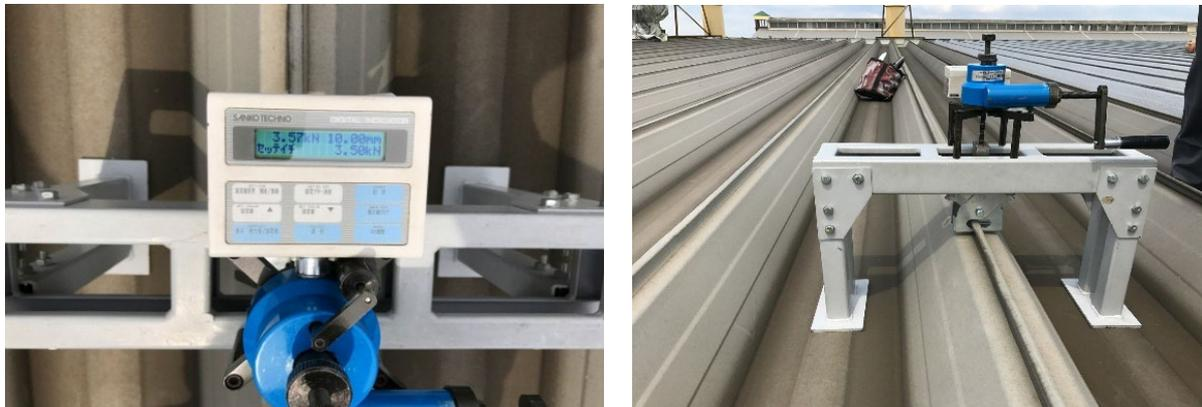
解図 3.2.5 折板屋根の吊子部分の強度確認事例
