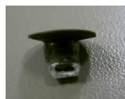
破断したブラインドリベット
