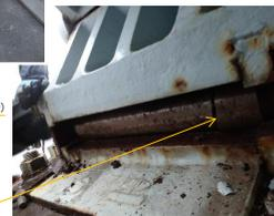
内部でローラーの破断を確認
