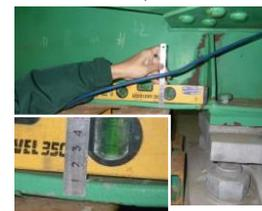
測定器具で計測することにより、5mmの変形が確認された。
