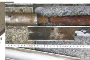
アーチ吊り部材の破断の例
