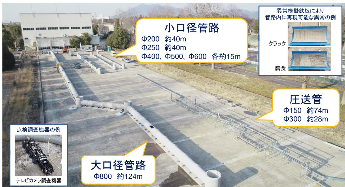
図6 下水道管路模擬施設の俯瞰図
