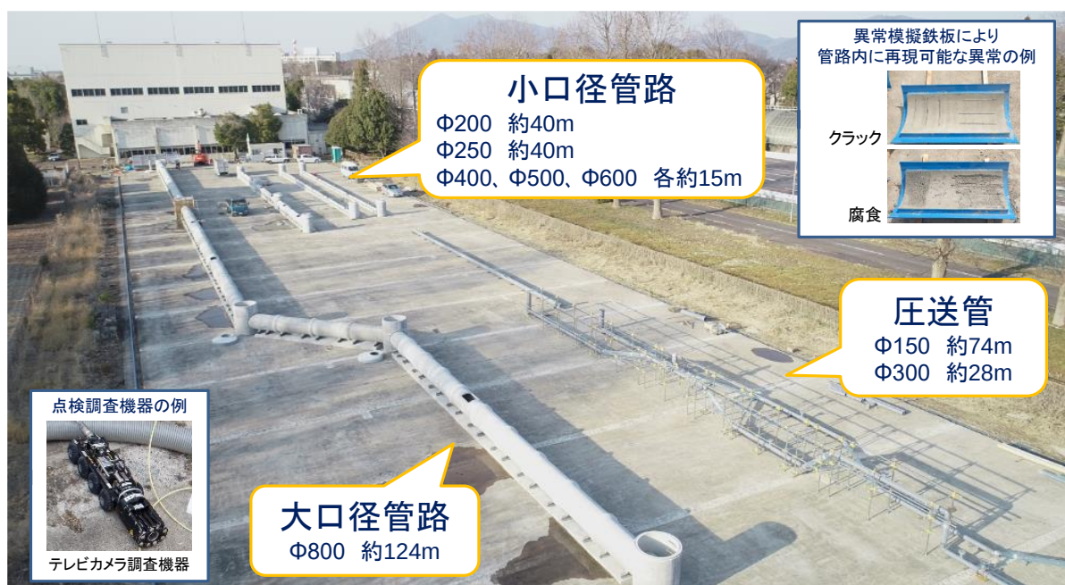
図6 下水道管路模擬施設の俯瞰図
