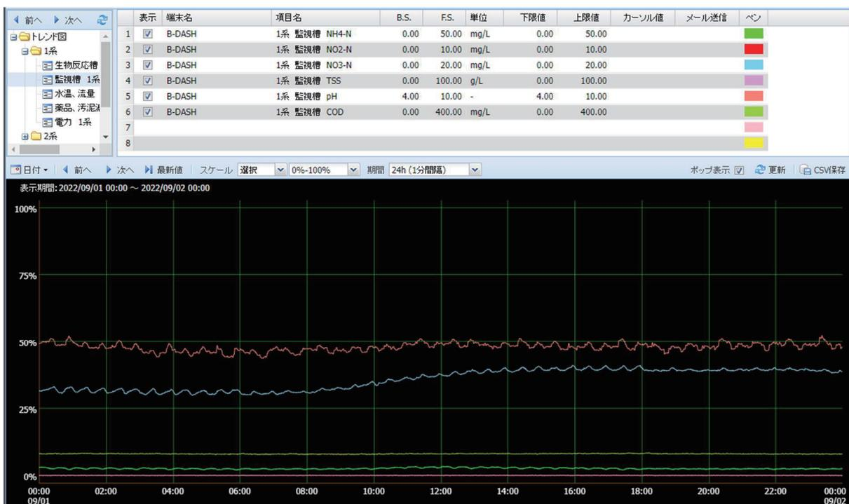
図 資 1-3-27 監視槽 NH<sub>4</sub>-N・NO<sub>2</sub>-N・NO<sub>3</sub>-N・TSS・pH・COD のトレンド
