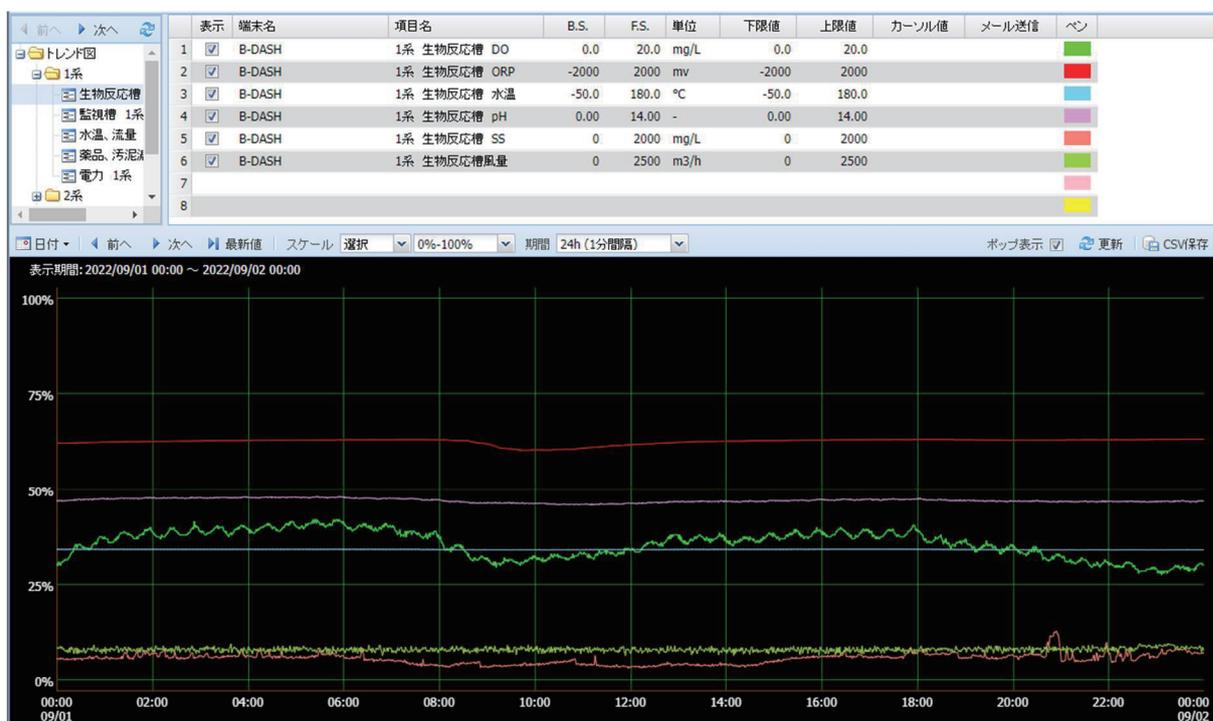
図 資 1-3-26 生物反応槽 DO・ORP・水温・pH・SS・風量のトレンド
