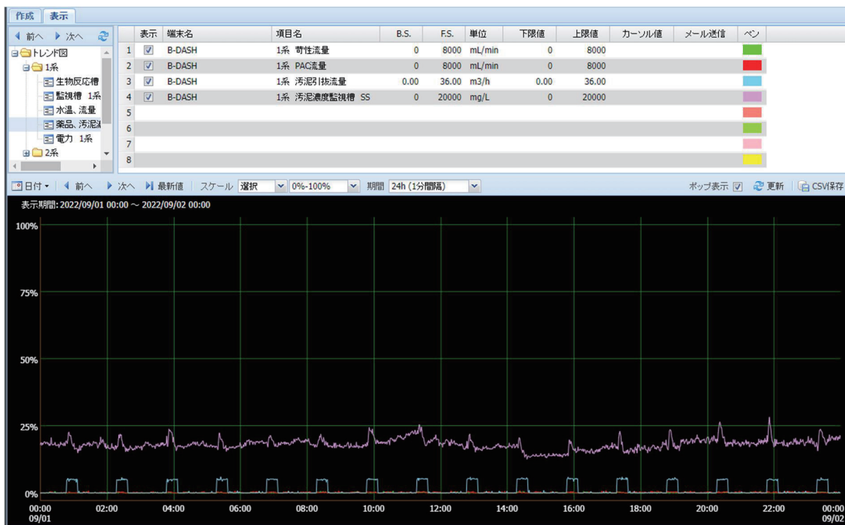
図 資 1-3-29 苛性ソーダ流量・PAC 流量・汚泥引抜量・汚泥濃度監視槽 SS のトレンド
