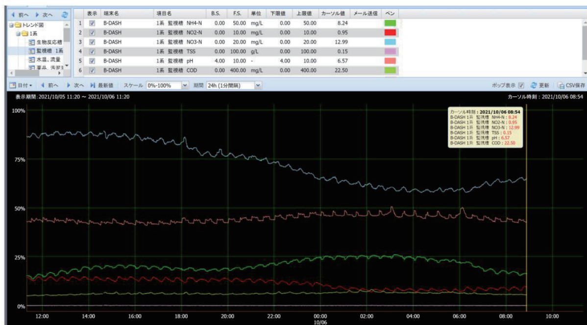
図 資 1-3-25 クラウド型遠方監視システムのトレンド監視画面（放流水質）
