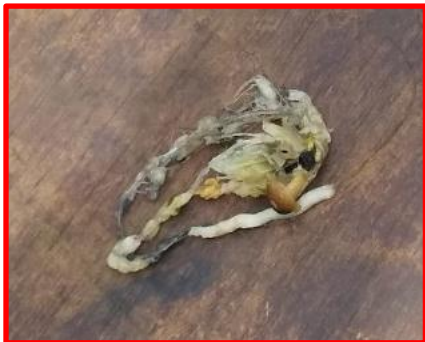
エアロック※：空気孔のし渣詰まり
