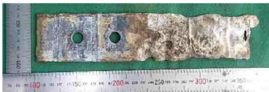
図- 2.3.10.19 補強材の腐食状況
