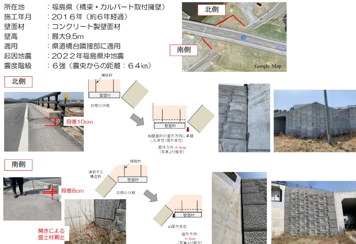
図- 2.3.1.14 事例：タ 3 の変状概要図
