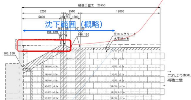
図- 2.3.1.26 事例：ジ6の路面の段差の状況
