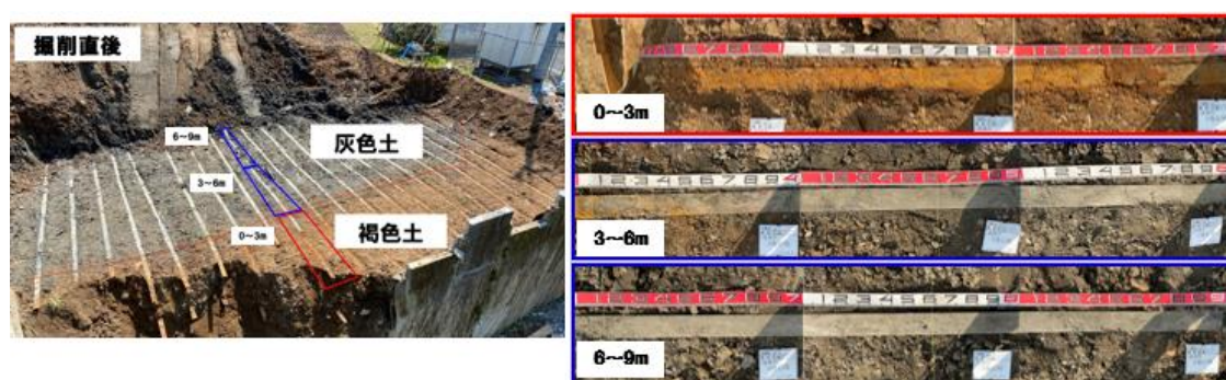
図- 2.3.10.13 現場調査測点(左)、補強材腐食状況(右)
