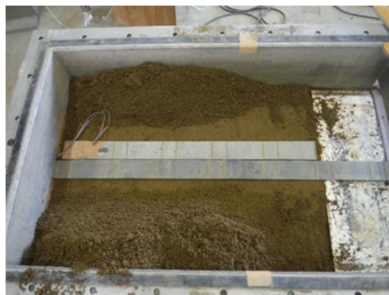
(b) 試験補強材設置状況 (Case.4 平行)
