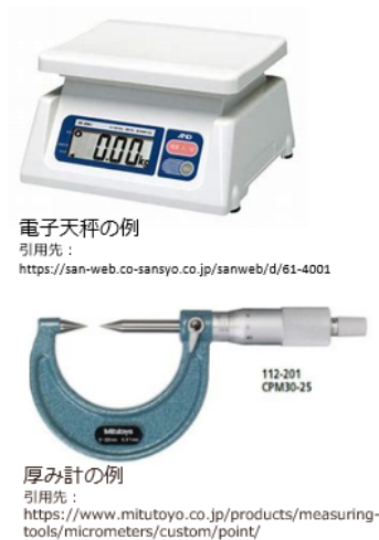
図- 2.3.10.7 腐食減量の測定方法（重量測定、肉厚測定）
