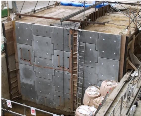
図- 2.3.9.13 実大補強土壁模型（壁高 H = 6.0\text{m} ） 2.3.9-6)
