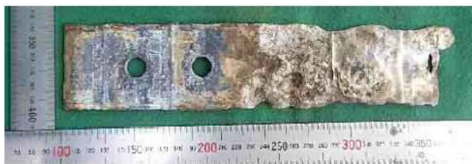
図- 2.3.10.19 補強材の腐食状況
