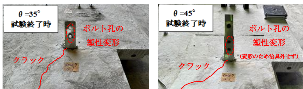
図- 2.3.6.14 実験終了時の部材の状態
