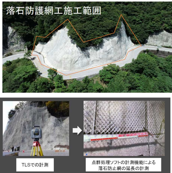
図-1 地上型レーザースキャナー（TLS）を用いた出来形管理の現場での確認試験
