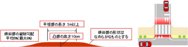
図-1 左：ハンプの標準構造 右：幹線道路から生活道路への入口に設置するスムーズ横断歩道
