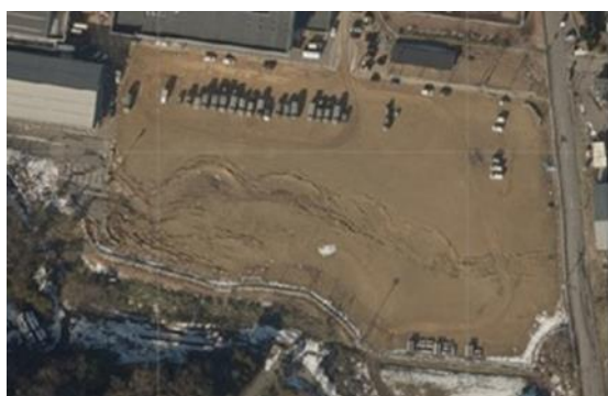
写真 5. 4. 2-42 校庭の地割れ全景 5.4-12)
