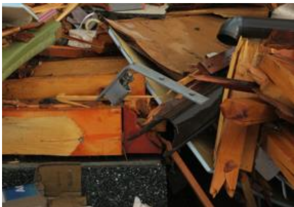
写真5.2.2-46 写真5.2.2-44のホールダウン金物
