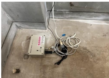
写真 4.4-3 強震計設置状況 (WJMS2：南西側1階、CV374_144)
