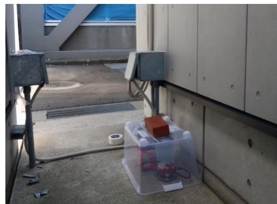
写真 4.4-18 地震計設置状況 (WJMZ、Atom No.6_162)
