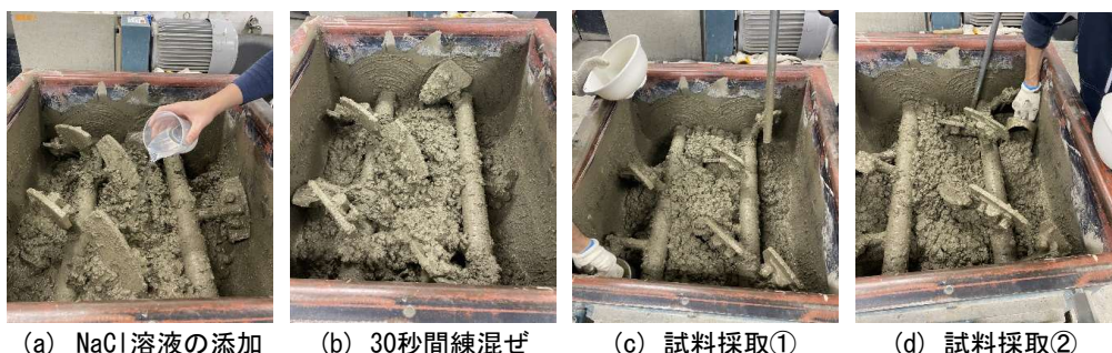
解説写真3 塩化ナトリウム水溶液の後添加、練混ぜおよび試料採取の状況
