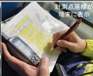
赤谷地区の河道閉塞部を対象として、土砂災害緊急情報の通知に必要な決壊氾濫シミュレーションに用いる河道閉塞の大きさを計測する訓練を実施しました。
