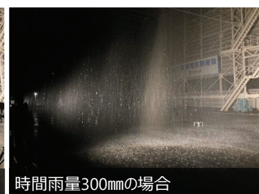
大型降雨実験施設に、カメラと複数の照明を設置して、昼間、夜間ともに降雨強度や照明位置を変えながら撮影を行いました。（黄丸は照明）
