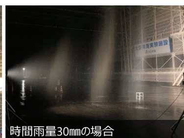
大型降雨実験施設に、カメラと複数の照明を設置して、昼間、夜間ともに降雨強度や照明位置を変えながら撮影を行いました。（黄丸は照明）
