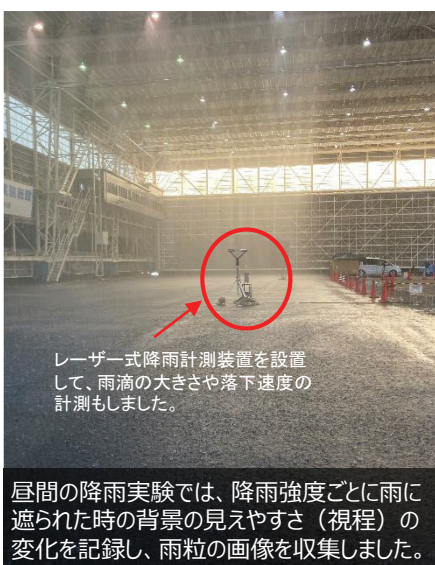
大型降雨実験施設に、カメラと複数の照明を設置して、昼間、夜間ともに降雨強度や照明位置を変えながら撮影を行いました。（黄丸は照明）
