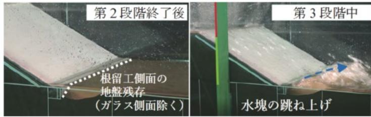
写真-3.6.5 ケース5の状況(目標越波流量 $0.05\text{m}^3/\text{s}/\text{m}$ 、異形根留工b)
