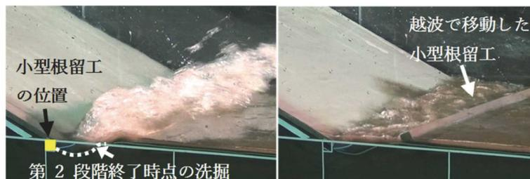
写真-2.2.4.1 根留工流失からの破壊状況（竹下ら、2017a）
