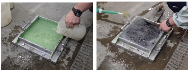
a) 型枠内に水を注入 b) 水をかけながら敷均し
