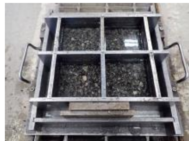
写真-6 幅10cm×長さ10cm×高さ10cmの型枠に基層用の加熱混合物を設置した状態
