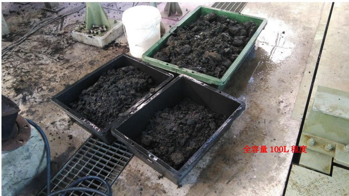
図資 3-2 乾燥機内より排出された脱水汚泥
